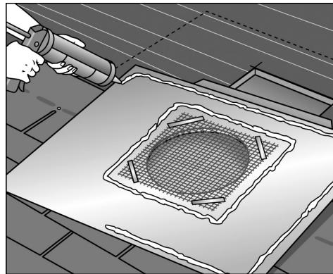
**2. SELLE** usando cantidad suficiente de sellador localmente aprobado (Clase A donde sea requerido por código para la resistencia de fuego) de alrededor del interior y exterior de la pestaña.
