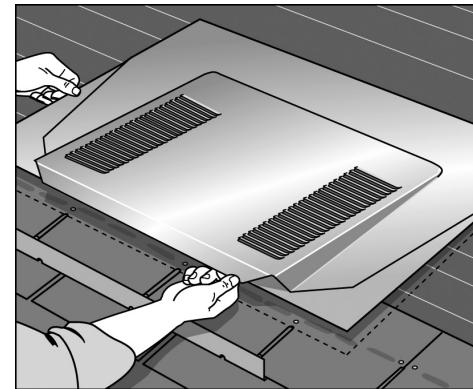
**3. COLOQUE** la ventila directamente sobre la abertura de 11-pulgadas x 11-pulgadas, anteriormente marcada alrededor como una guía.
