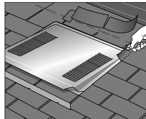
**6. RECORTE** las tejas, una pulgada en las parte de arriba, y lo suficiente en los otros lados de la ventila para permitir el desagüe.
