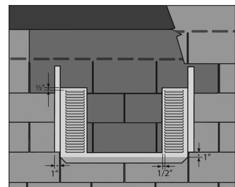
**2. EMPEZANDO CON HILERA 1**, alinee y sujeté a la parte de arriba de la ventila como se muestra usando despegue y adhiere, cinta de dos caras, o sellador (Clase A donde sea requerido por código para la resistencia de fuego). Repita con hileras 2 y 3 para completar el método de terminación sobre tablilla.
