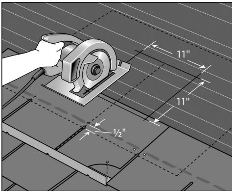
**1. MARQUE Y CORTE\*** Alinea el frente de la ventila  $\frac{1}{2}$  pulgada debajo de la línea de clavos y marque el perfil de la ventila para después colocar. Marque el perfil de una abertura de 11-pulgadas x 11-pulgadas. Con la navaja ajustada al grosor de la capa, corte el agujero en la superficie del techo.
