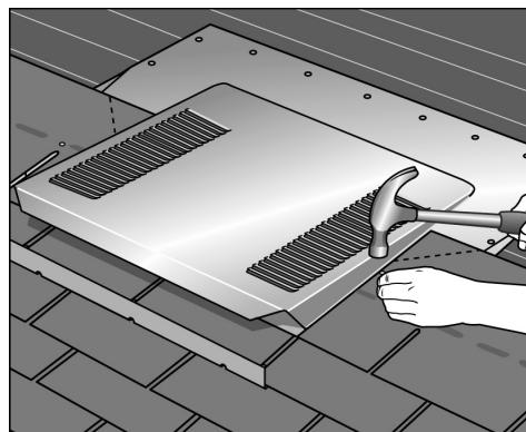
**5. CUBRA** las tejas alrededor de la ventila. Basada en las mejores prácticas locales, se puede hacer una abertura de 45-grados en las tejas terminando en la ventila. **Mire Paso 5a. si esta instalando método de terminación sobre tablilla.**
